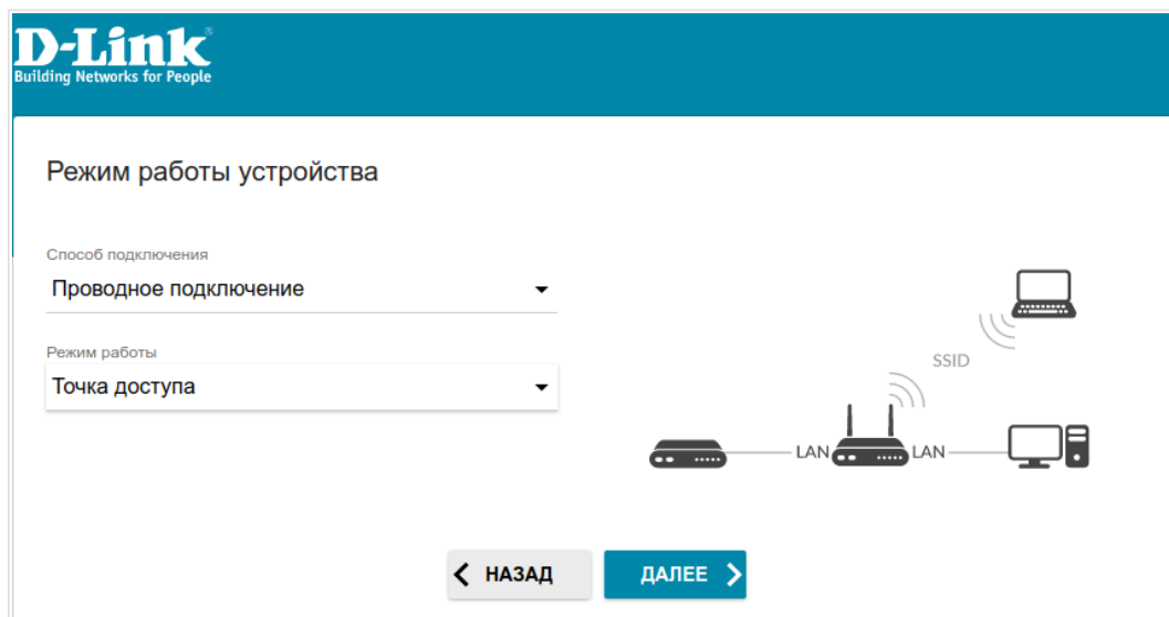
Рисунок 37. Выбор режима работы устройства. Режим Точка доступа .
