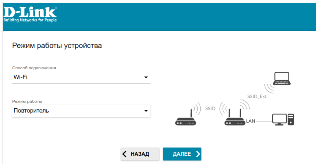
Рисунок 39. Выбор режима работы устройства. Режим Повторитель .
