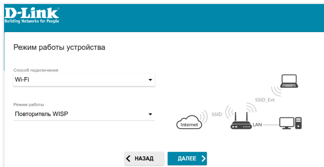
Рисунок 38. Выбор режима работы устройства. Режим Повторитель WISP .
