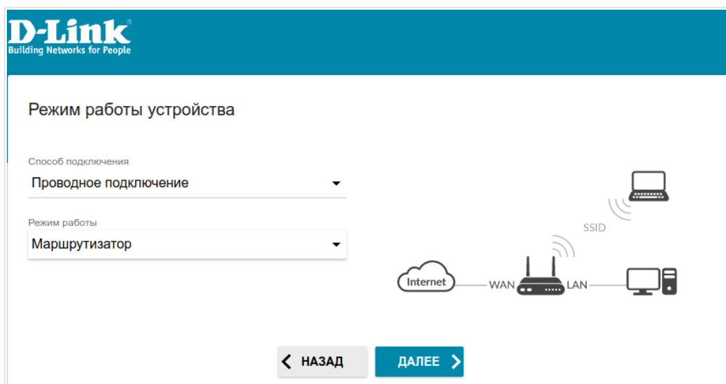
Рисунок 36. Выбор режима работы устройства. Режим Маршрутизатор .
